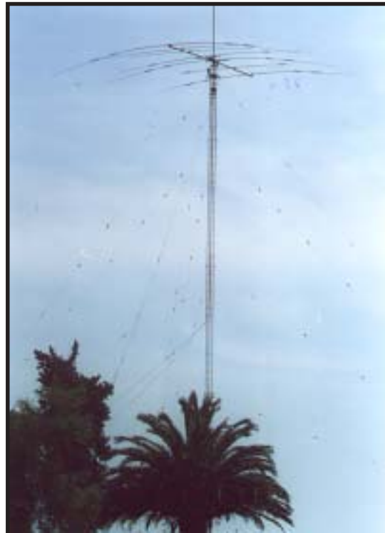
Foto: Antena Mosley multibanda instalada y funcionando, incluye bandas War.
